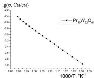
Электропроводность поливольфрамата  $\text{Pr}_{10}\text{W}_{22}\text{O}_{81}$  оказалась значительно выше проводимости  $\text{Pr}_2(\text{WO}_4)_3$ , что делает перспективным дальнейшее исследование его транспортных свойств.
